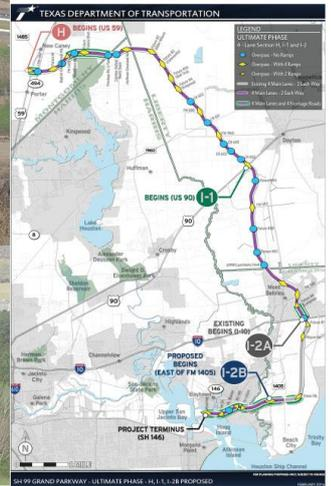
El tramo I-1A de Grand Parkway está ubicado al este de Houston y se extiende desde el puente sobre la US90 hasta la estación 2+880, justo al sur de la SH 146. Este tramo incluye un total de 12 puentes con una longitud total de 4.1km. Los vanos máximos son de 50m para vigas de hormigón pretensado y de 70m para vigas de acero. Entre estos puentes se encuentra el Puente 8 con 50 vanos y una longitud total de 1920m.
